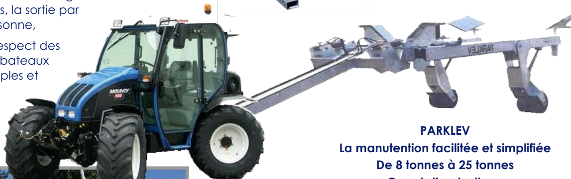
Parklev en attelage avec un tracteur REFORN METRAC
